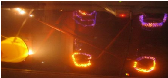
Phóng điện vàng quang MBA (Thí nghiệm tại xưởng)
